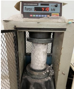
Gambar 6. Pengujian Kuat Tekan beton
