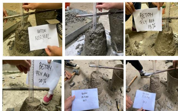
Gambar 4. Pengujian Slump Test
